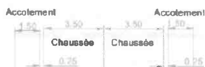
Figure 37 - Profil en travers type de l'avenue Pinay rétablie avec aménagement de mode doux Du giratoire dénivelé jusqu'au carrefour avec l'avenue Delecroix (M952 nord)
